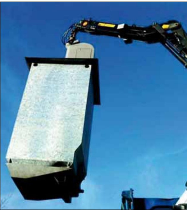
* Pour être vidées, les colonnes enterrées sont soulevées à l'aide d'une grue. Chaque colonne a une capacité de 3 m 3 , soit une tonne de verre. Profitons-en pour trier le plus possible nos emballages en verre.
